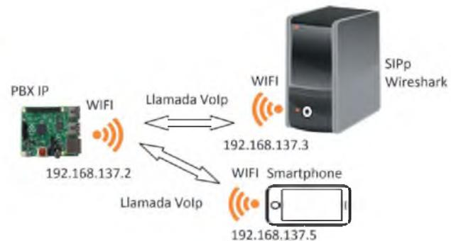
Figura 4. Escenario de pruebas conectando el generador SIPp y el PBX IP por medio de WiFi.
