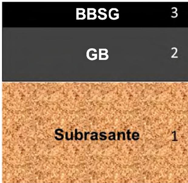
**Figura 4.** Estructura pavimento semi-flexible modelada. Fuente: propia
