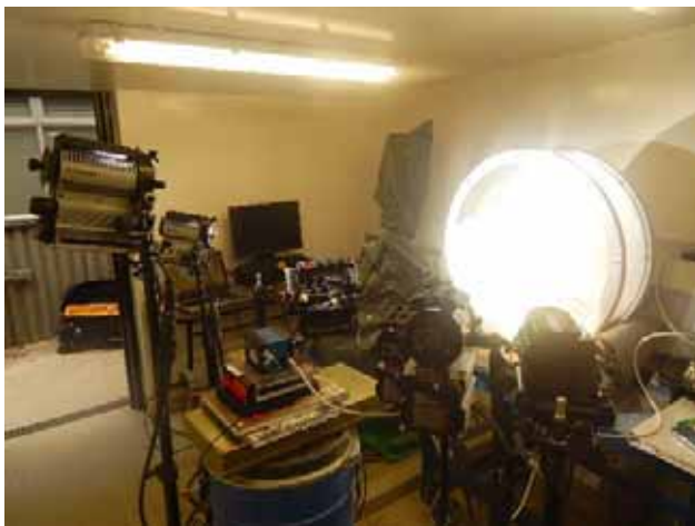
Figura 3. Montaje de ensayo para la grabación de imágenes de alta velocidad.
