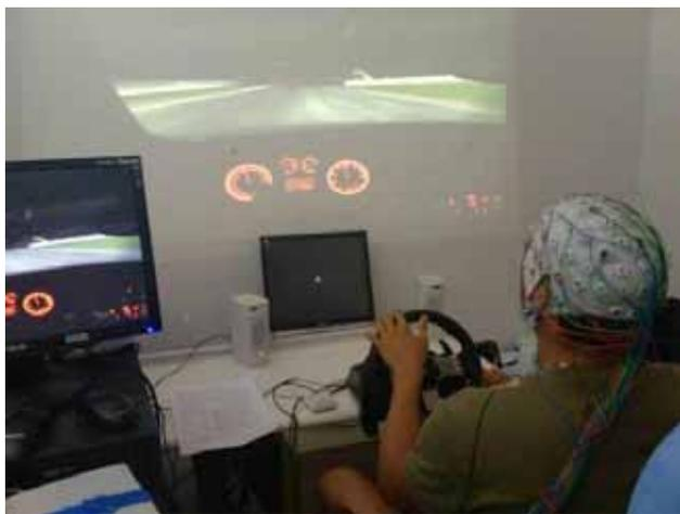
**Figura 3.** Ambientes simulados para pruebas de sistemas de detección de somnolencia por medio de EEG (Maglione, y otros, 2014)
