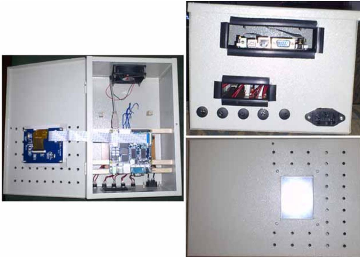
Figura 10. Caja metálica para la board ARM mini2440 y la etapa de potencia.
