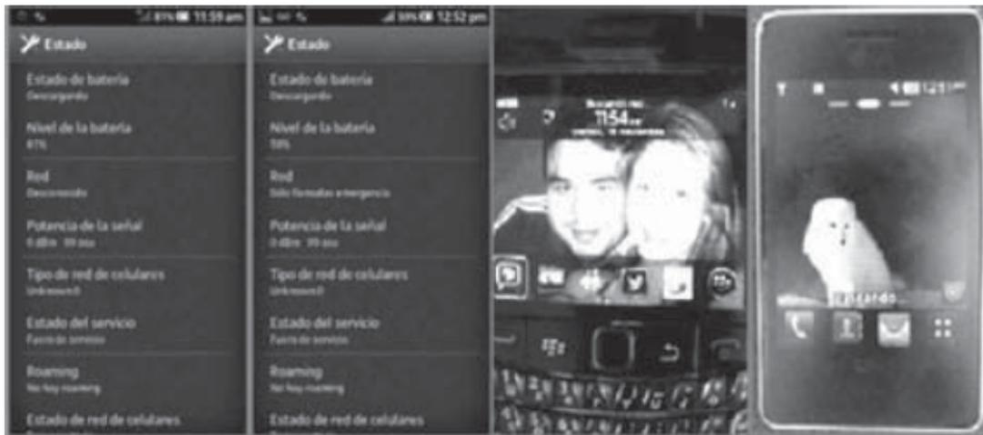
Figura 12. Los celulares cuando el prototipo inhibidor está encendido.
