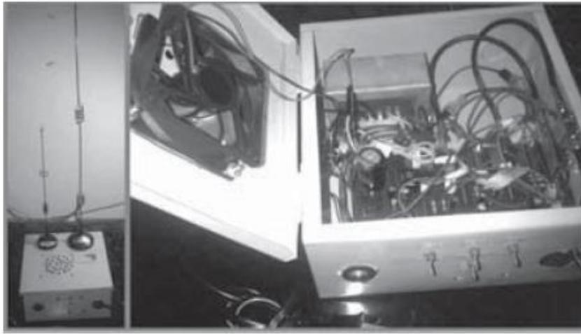
Figura 13. Prototipo inhibidor de señal celular construido.
