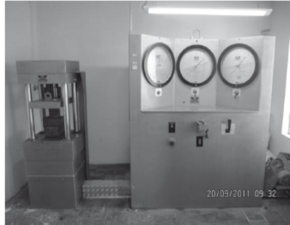
Fig. 1. Equipo de ensayo a compresión paralela.
