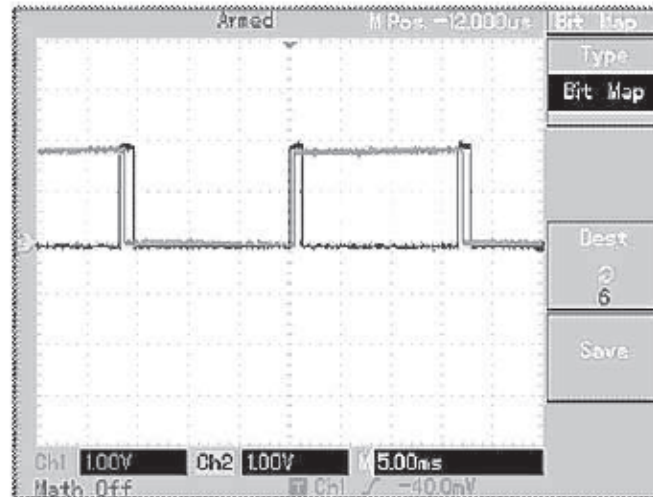
Figura 10. Señal identificador de campo par/impar y señal de sincronismo vertical.
