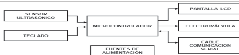
Figura 1. Diagrama de bloques de la tarjeta de control.
