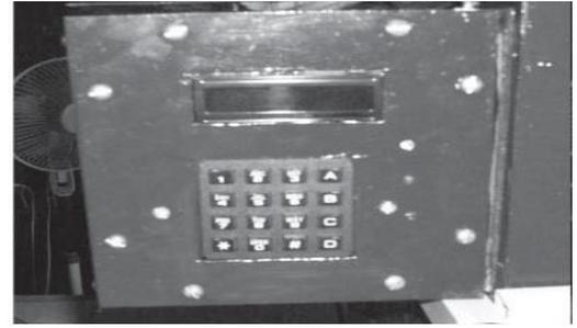
**Figura 4.** Panel frontal de la secadora
