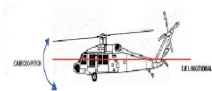
Figura 2. Actitud de cabeceo del helicóptero sobre el eje longitudinal.
