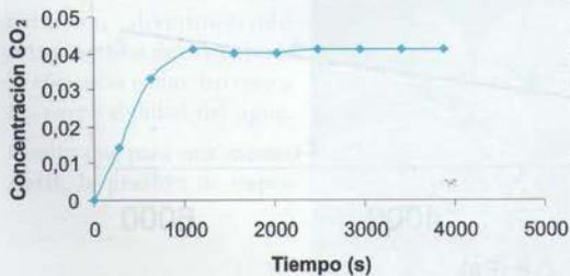
Figura 6. Variación de la concentración de  $CO_2$  en la cámara de medida.
