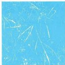
Foto 1. Carbonatos Sobre la Superficie (Concreciones Blancas).
